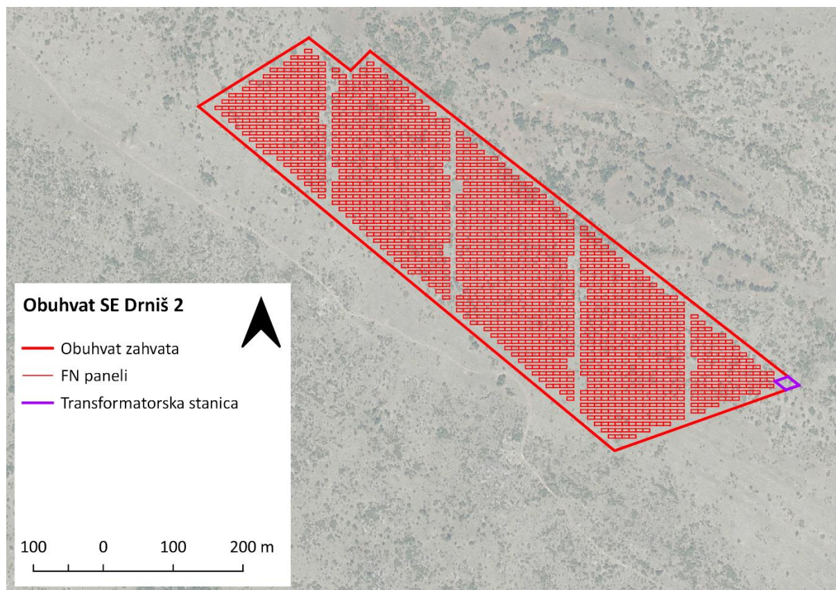
Slika 2.4 Tlocrtni prikaz rasporeda fotonaponskih panela i transformatorske stanice unutar obuhvata zahvata SE Drniš 2 (autor: Geonatura d.o.o.)
