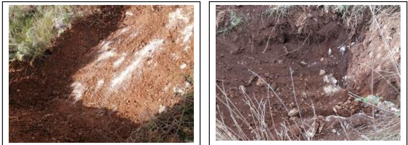
Slika 10. i 11. Matična stijena uglavnom je prekrivena slojem gline prašinstave s udjelom kršja stijene, a debljina pokrivača registrirana iskopom jama iznosi od 0.28 do 1.05 m.
